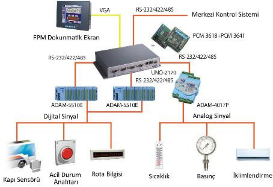
Şekil 14. Tren İzleme ve Bilgilendirme Sisteminin Elemanları
