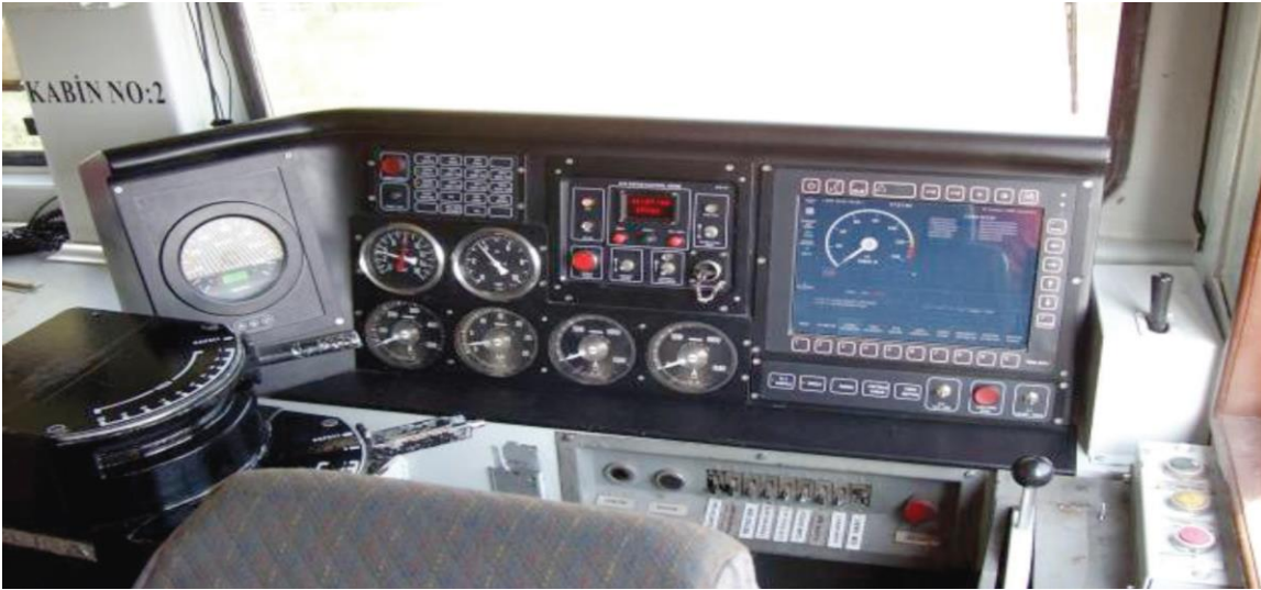
Şekil 9. Tren Denetim Sistemi
